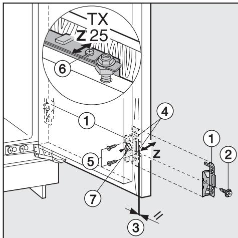
■ Привинтите крепежный уголок ① с помощью шестигранных болтов ② к дверце прибора, в которой предварительно были просверлены отверстия.
